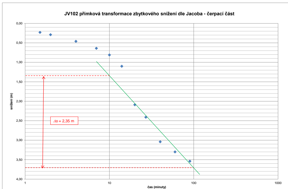
Obrázek č. 4 Přímková transformace zbytkového snížení – čerpací část ve vrtu JV102
